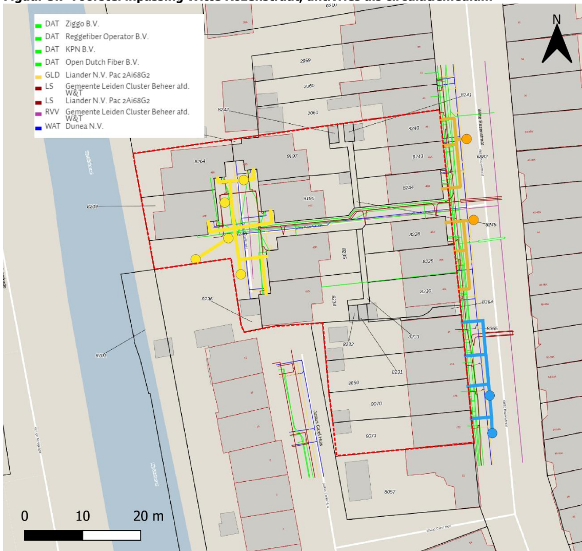
Figuur 5.7 Voorstel inpassing Witte Rozenstraat, antivries als circuliatiemedium
